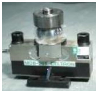
Рисунок 4 – Вид датчика семейства MDB с узлами встройки
