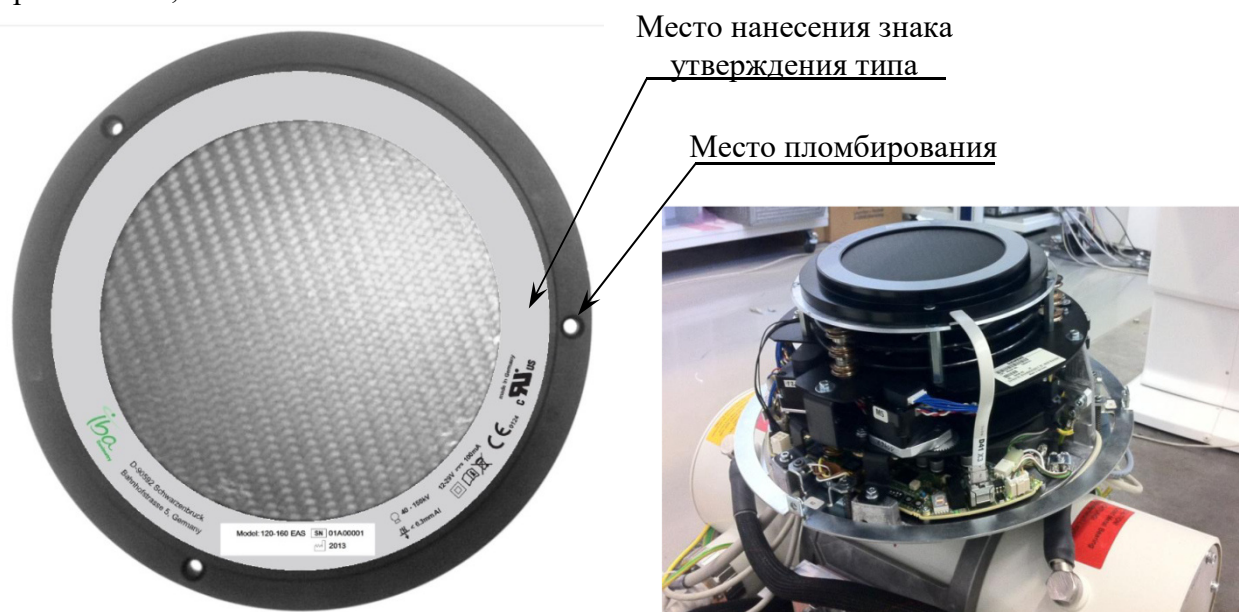
Рисунок 1 – Общий вид измерителя производства дозы на площадь KermaX plus 120-160 EAS (вид сверху и размещение на диафрагме коллиматора рентгенографической установки) с указанием места нанесения знака утверждения типа и места пломбирования
