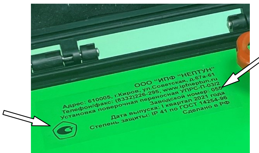
Рисунок 3 – Обозначения мест нанесения знака утверждения типа и заводского номера установок поверочных переносных УПРС-П
