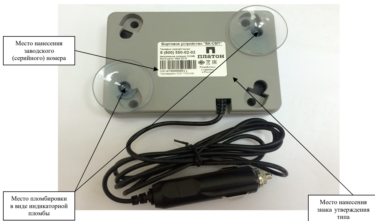
Рисунок 3 – Общий вид средства измерений с указанием мест пломбировки (индикаторных пломб), мест нанесения знака утверждения типа, заводского или серийного номера.
