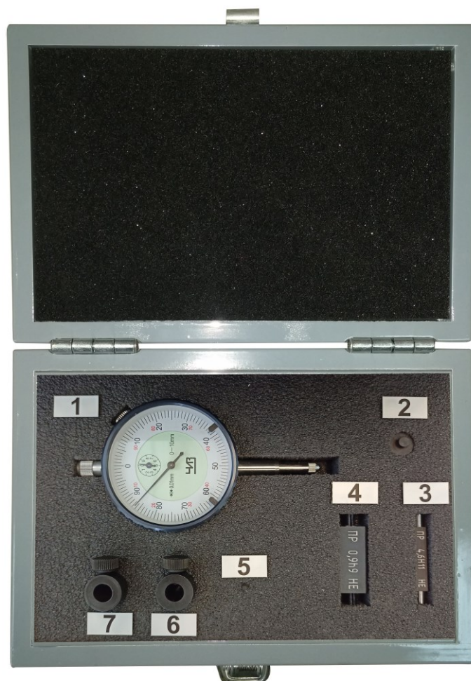
1 – индикатор часового типа ИЧ10; 2 – штырь; 3 – втулка 1 с поджимным винтом; 4 – втулка 2 с поджимным винтом; 5 – наконечник измерительный; 6 – калибр-скоба 0,9h9; 7 – калибр-пробка 4,6H11
