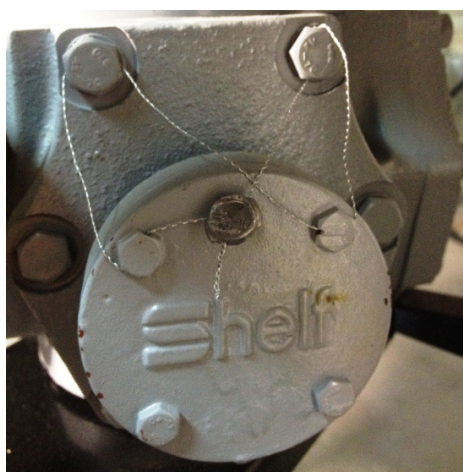
Рисунок 5 - Пломбировка измерителя объема типа Shelf, для модуля СУГ
