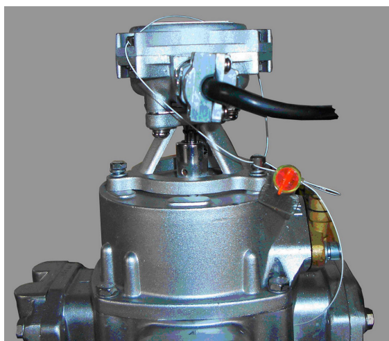
Рисунок 3 - Пломбировка датчика импульсов ДИФВ-2
