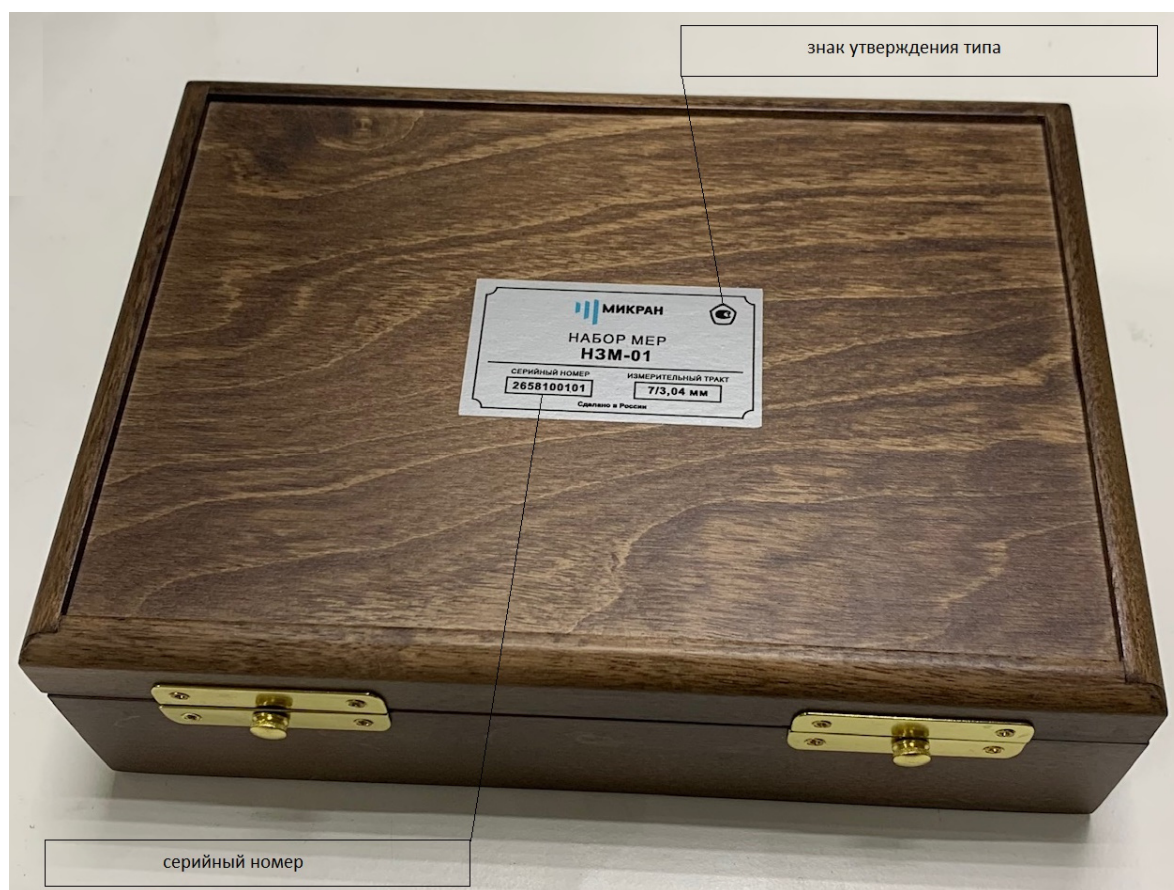
Рисунок 3 – Общий вид набора мер и места нанесения серийного номера и знака утверждения типа
