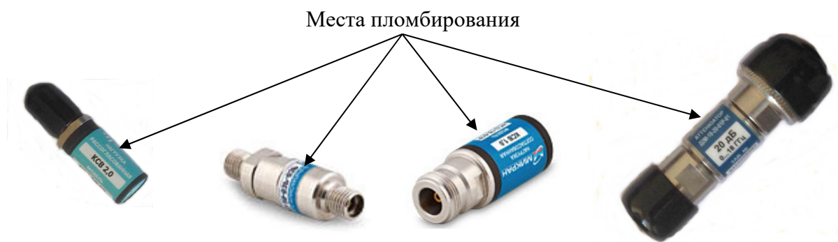
Рисунок 2 – Места пломбирования нагрузок и аттенюаторов (наклейки)
