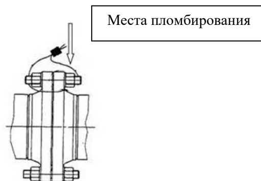
Рисунок 3 – Схема пломбировки от несанкционированного доступа, обозначение места нанесения знаков поверки на фланцевые соединения расходомеров массовых Promass, входящих в состав установки
