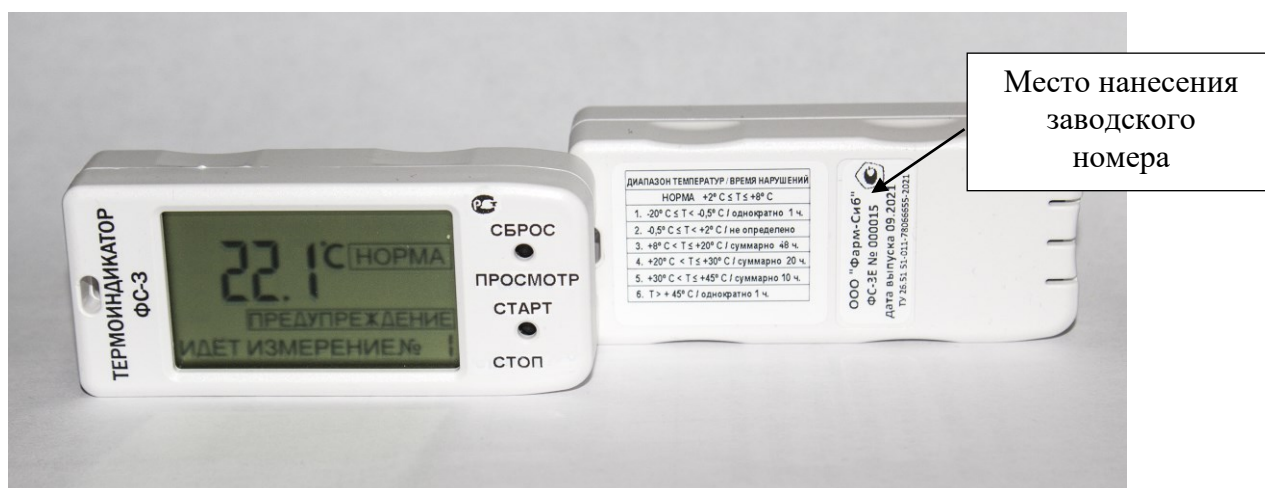
Рисунок 1 – Общий вид термоиндикаторов с диапазоном «НОРМА» 3 (от +2 до +8 °С).
