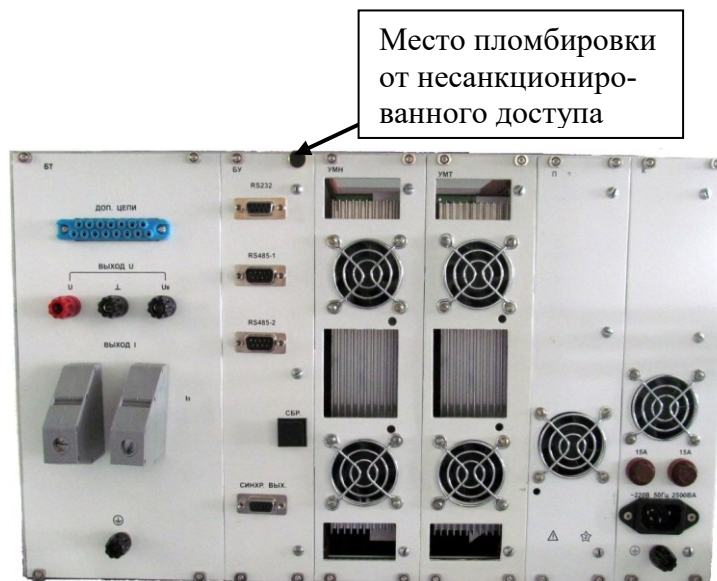
Рисунок 2 – Место пломбировки однофазных источников
