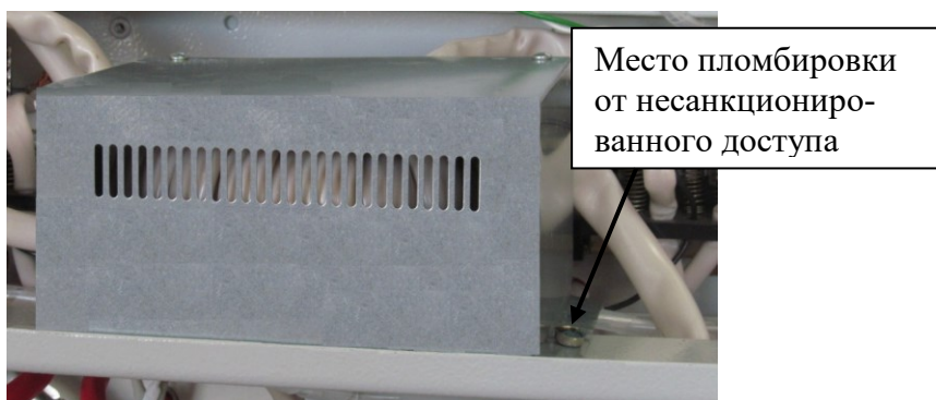
Рисунок 3 – Место пломбировки встроенных пассивных изолирующих трансформаторов тока
