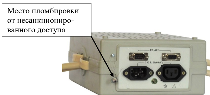
Рисунок 4 – Место пломбировки встроенных активных изолирующих трансформаторов тока
