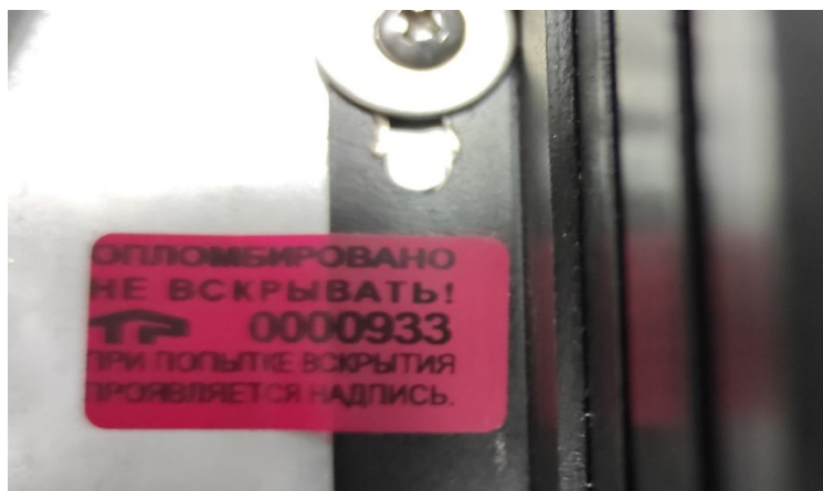
Рисунок 1 – Место пломбировки от несанкционированного доступа
