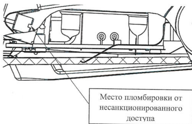
Рисунок 3.1 – Схема пломбировки от несанкционированного доступа
