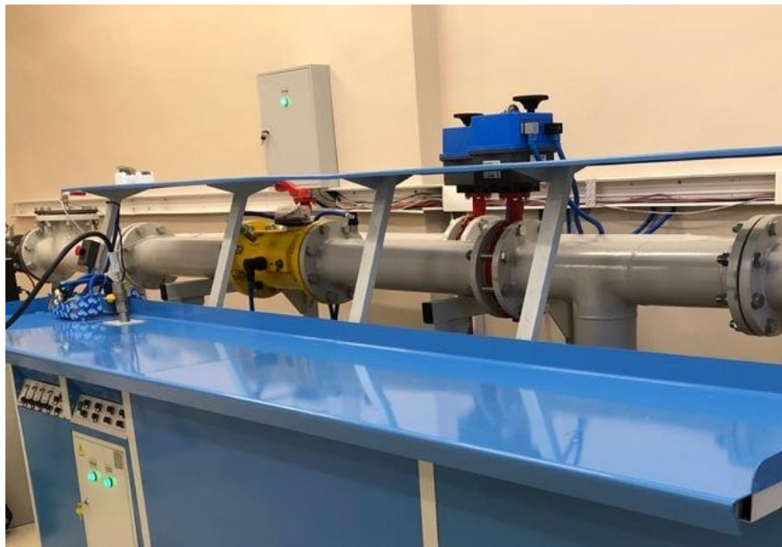
Рисунок 3 – Общий вид установок поверочных газовых «Аврора» модификации V на базе счетчиков газа
