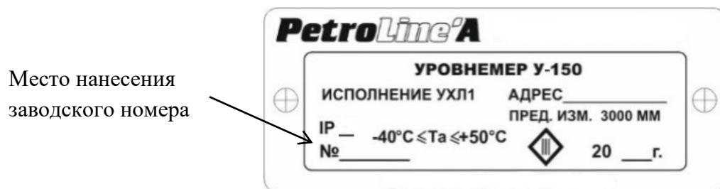
Рисунок 2 – Место нанесения заводского номера
