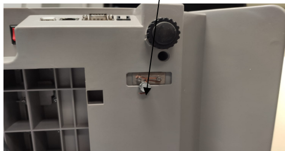
Пломба, место нанесения знака поверки
