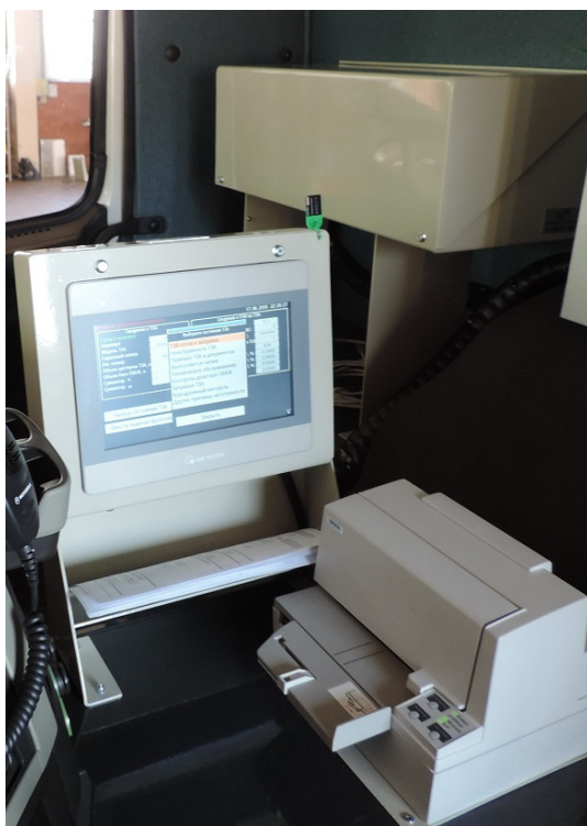
Рисунок 3 – Общий вид составных частей системы (БСК с закрытой защитной крышкой, ПОС-10, принтер) в кабине средства заправки
