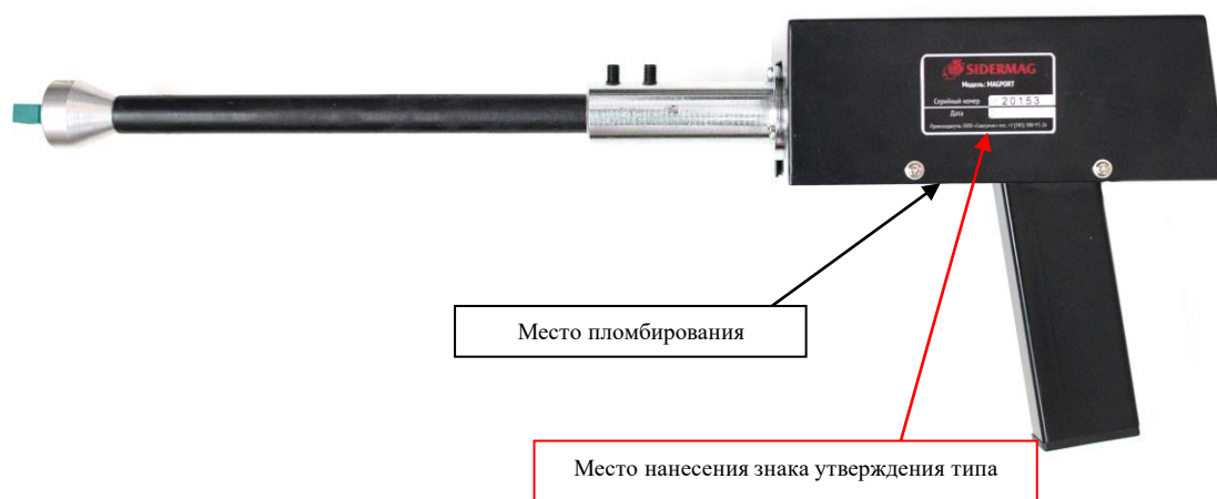
Рисунок 2 – Схема пломбировки измерителя с термопреобразователем типа К
