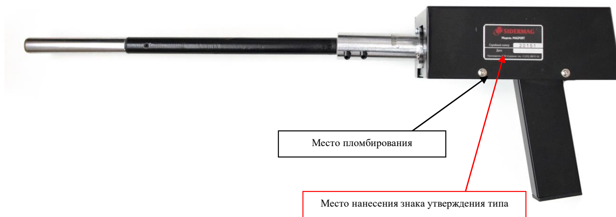
Рисунок 3 – Схема пломбировки измерителя с термопреобразователем типа S или B
