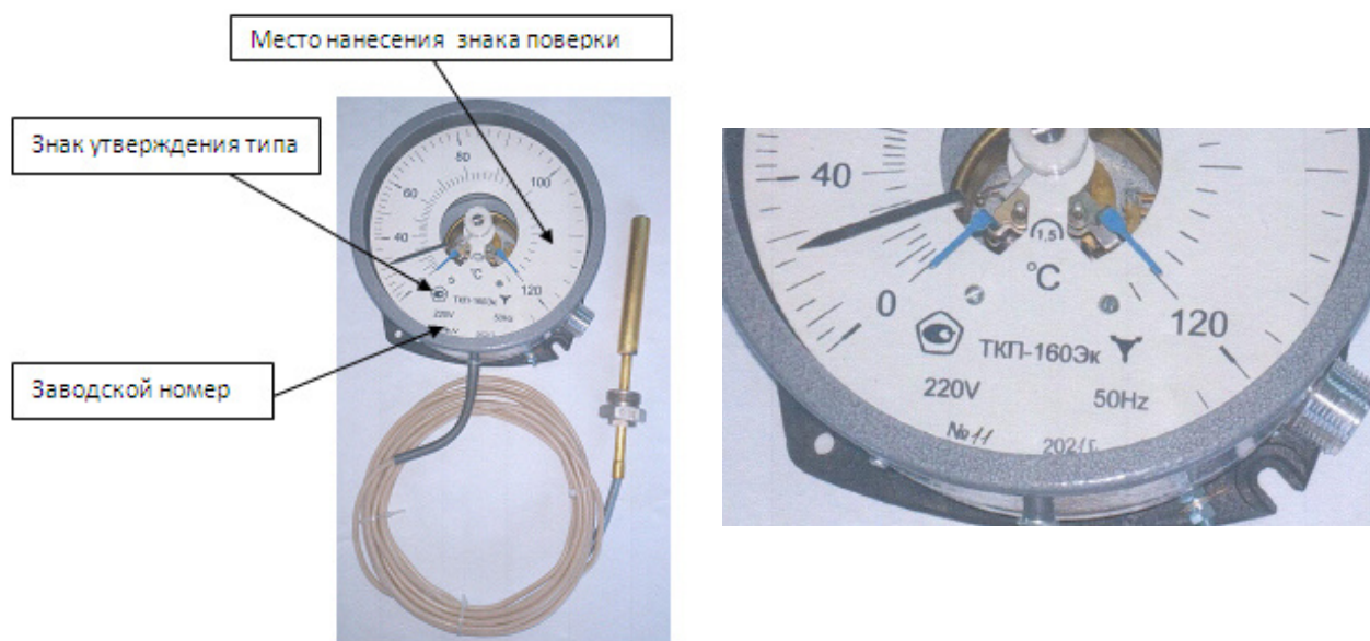
Рис.1-Общий вид термометров с указанием мест нанесения знака поверки, знака утверждения типа, заводского номера
