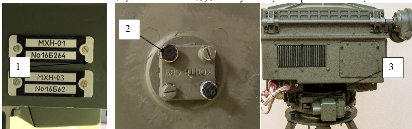
Рисунок 2 – Общий вид маркировки на корпусе блока МХН-01 и схема пломбирования 1- Заводской номер блока МХН-01, 2 - место пломбировки блока МХН-01, 3 – место нанесения знака утверждения типа.
