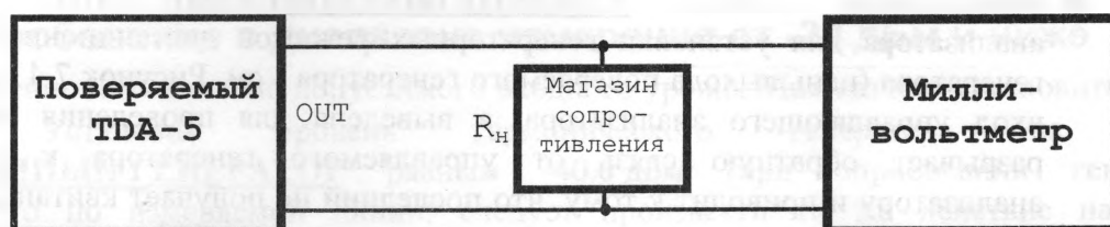
Рисунок 7.5. Проверка выходного сопротивления и установки уровня генерируемого сигнала
