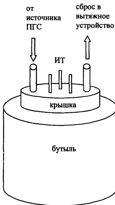
Рисунок 2 Схема газовых соединений при проверке экспозиционных трубок.
