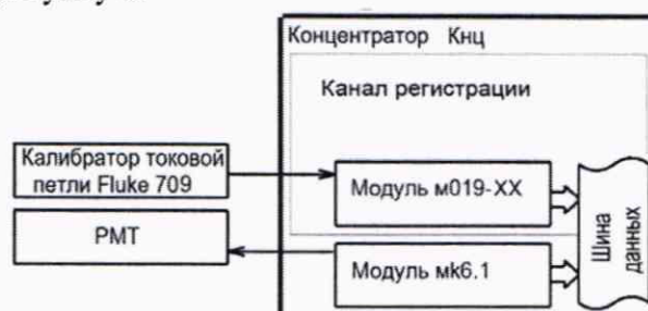
Рисунок 6 – Структурная схема соединений канала регистрации
