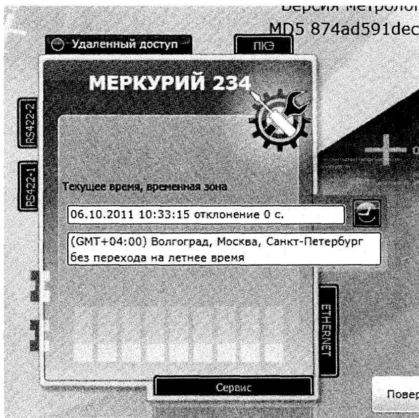
Рисунок 4 – Синхронизация времени модуля со временем РСТВ-01
