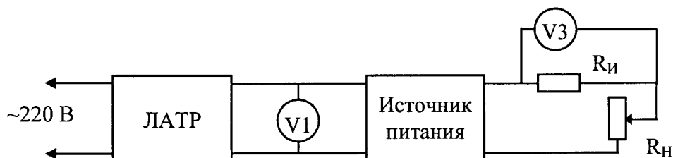
Рис. 3. Структурная схема соединения приборов для определения основной погрешности воспроизведения выходного тока.
