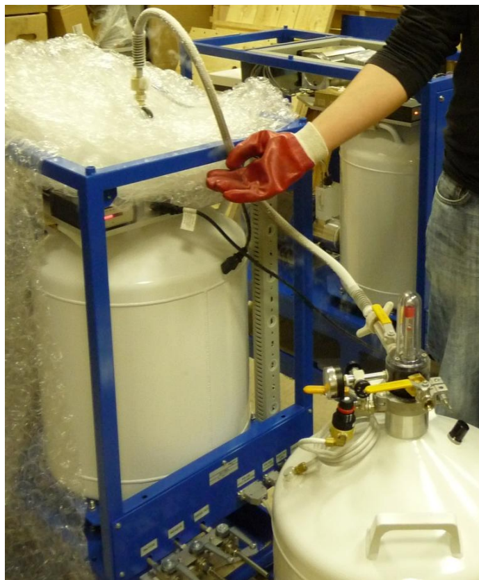
Рисунок 13 – Подготовка к заправке азотом сосуда Дьюара
