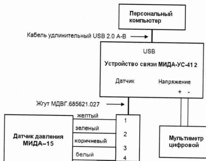
Рисунок Г.1- Блок-схема подключения датчика с выходным сигналом 0,5-4,5 В
