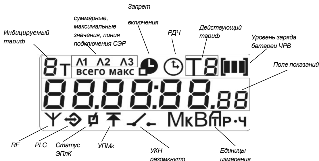
Рисунок Е.1 – Расположение полей дисплея счетчика
