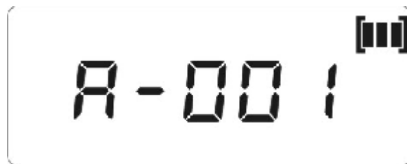
Рисунок Е.3 - Пример индикации версии счетчика
