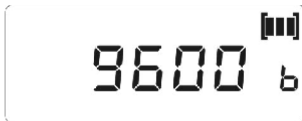
Рисунок Е.5 - Пример индикации скорости обмена интерфейса RS-485 счетчика (в примере – 9600 бод)
