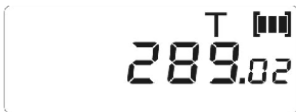
Рисунок Е.2 - Пример индикации типа счетчика
