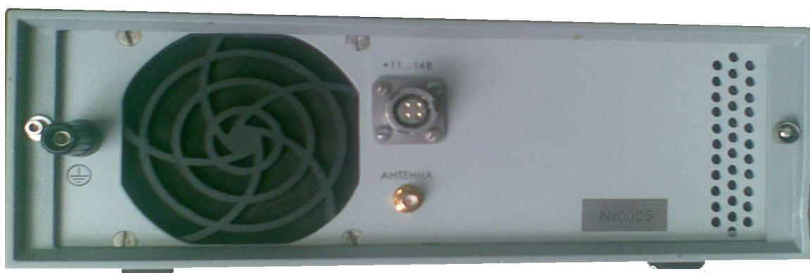
Рисунок 6.2. Расположение присоединительных разъемов на задней панели стандарта частоты рубидиевого Ч1-2010.
