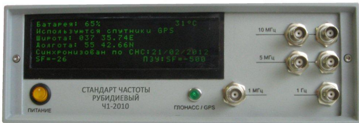
Рисунок 6.1. Индикация и расположение органов управления, присоединительных разъемов на передней панели стандарта частоты рубидиевого Ч1-2010.
