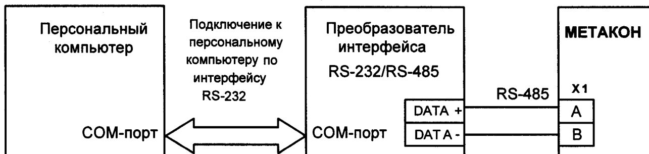
Рисунок А.6.3 – Схема подключения приборов МЕТАКОН к компьютеру через последовательный коммуникационный интерфейс RS-485
