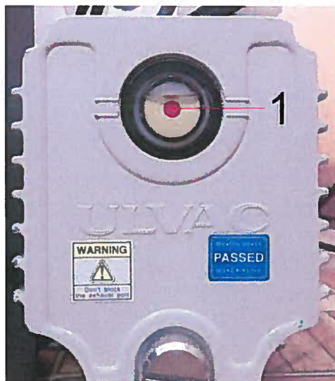
Рисунок 60. Индикатор уровня масла в вакуумном насосе.
