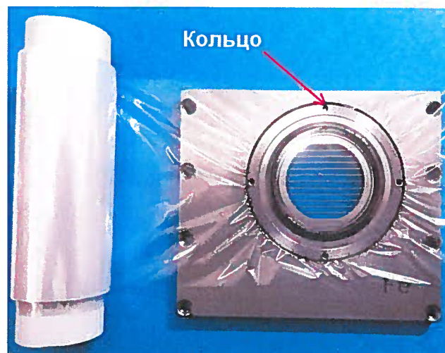
Рисунок 18. Фиксация пленки металлическим кольцом
