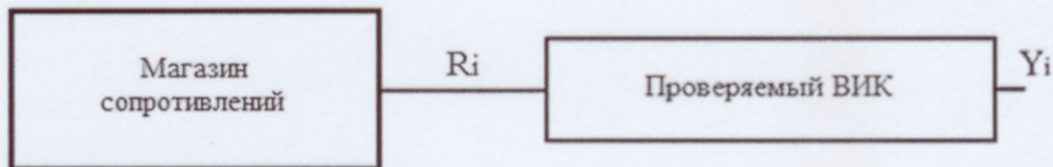
Рисунок 5 - Схема поверки ВИК сигналов от термопреобразователей сопротивления
