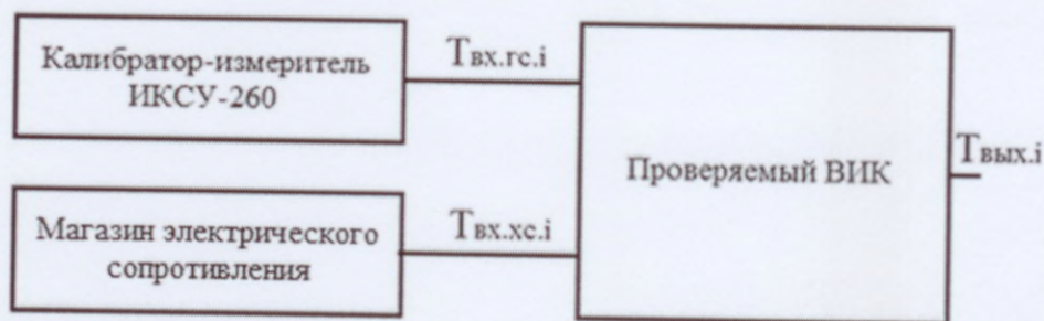
Рисунок 4 – Схема поверки ВИК сигналов от термопар с коррекцией по температуре холодных спаев
