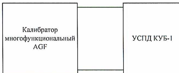
Рисунок 4 – Схема проверки пределов допускаемой относительной погрешности преобразования и измерения.
