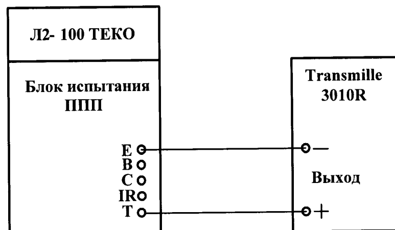
Рис. 4. Схема измерения тока коллектора.
