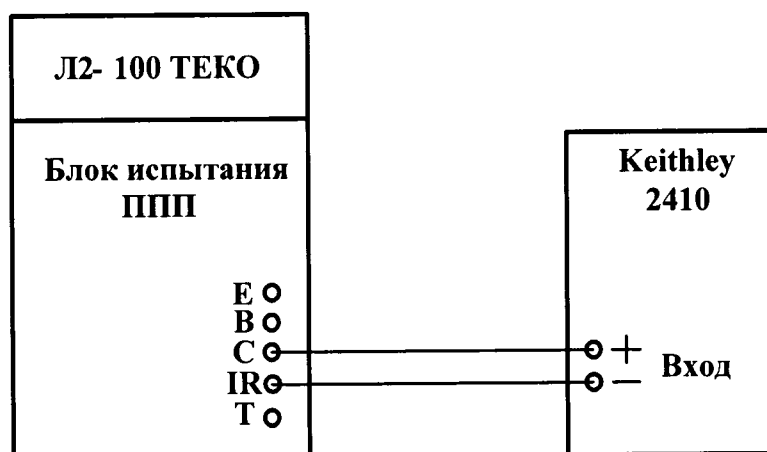
Рис. 5. Схема измерения начального и обратного тока.
