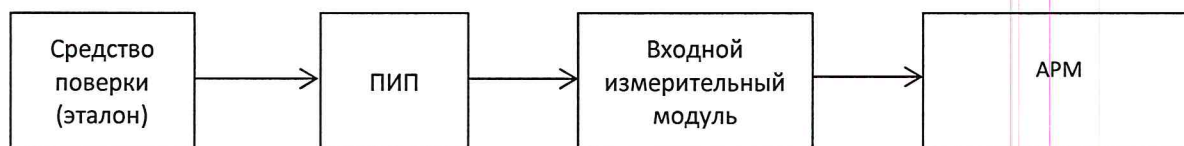
Рисунок 2. Общая схема проведения эксперимента при поверке ИК комплектным методом
