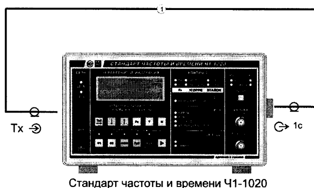
Рисунок 7.8 – Схема электрическая подключения сигналов для измерения случайной составляющей погрешности измерителя временных интервалов (1-ВЧ кабель ТСАБ.685661.002-02).
