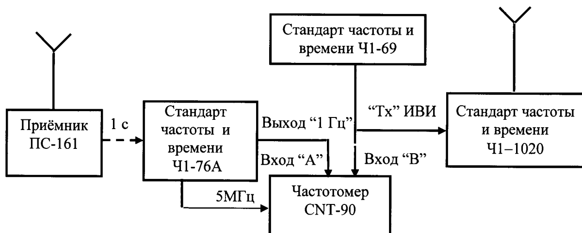
Рисунок 7.10 – Проверка погрешности определения расхождения шкалы времени контролируемого прибора и шкалы времени UTC(SU) встроенным ИВИ в режиме непрерывной синхронизации по сигналам ГНСС ГЛОНАСС и GPS и погрешности определения расхождения шкалы времени контролируемого прибора и шкалы времени UTC(SU) встроенным ИВИ после синхронизации ИВИ шкалой времени UTC(SU) за вычетом задержек в антенном тракте и приемнике на интервале наблюдения 10 минут.
