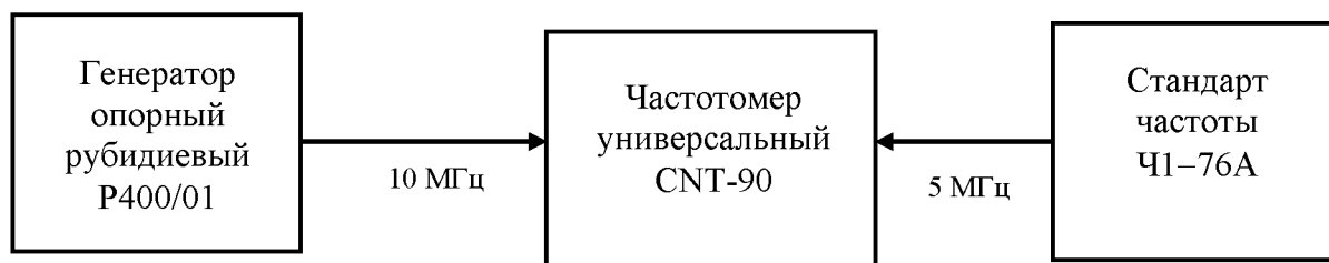
Рисунок 7.1 – Проверка номинального значения частоты выходного сигнала
