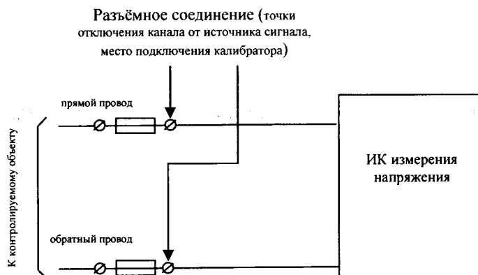
рис. 9.4 Схема поверки ИК измерения напряжения
