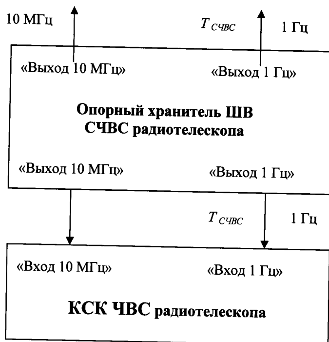
Рисунок 7 – Схема соединения ПКП и опорного хранителя шкалы времени СЧВС [n]
