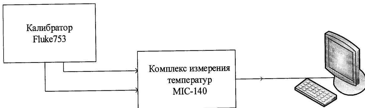
Рисунок 14 – Схема поверки ИК напряжения постоянного тока
