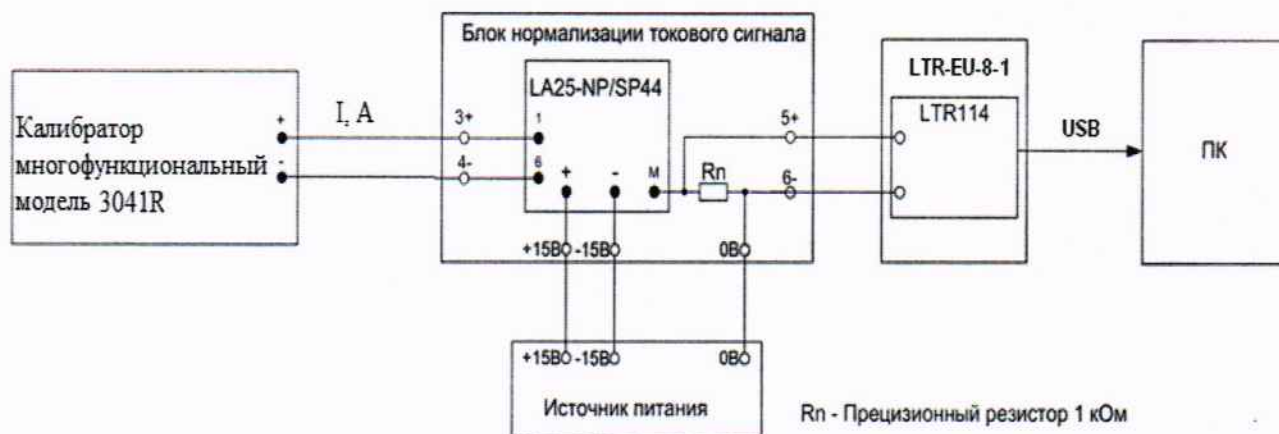
Рисунок 2 – Схема поверки ИК силы постоянного тока с помощью РЭТ (калибратор многофункциональный модели 3041R)
