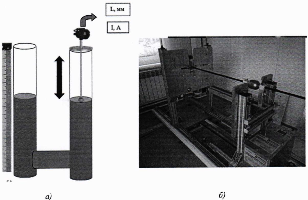
Рисунок 1 – Поверка датчика уровня на поверочной установке *а)* с непосредственным изменением уровня жидкости *б)* с имитацией изменения уровня жидкости
