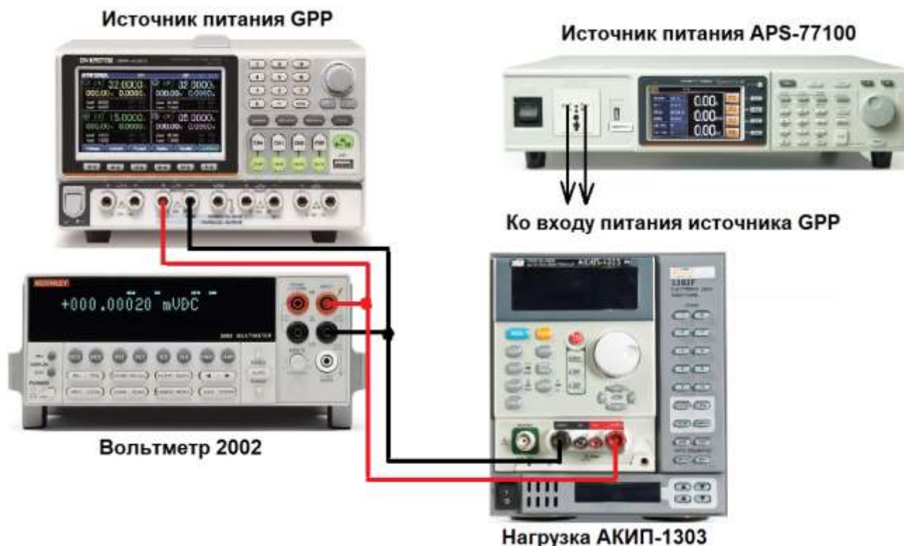
Рисунок 2 – Структурная схема соединения приборов для определения нестабильности выходного напряжения источников
