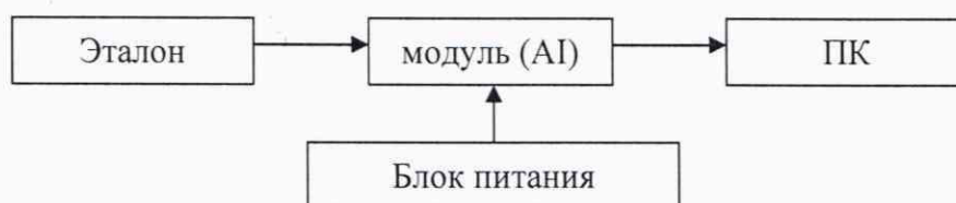
Рисунок 1 – Схема подключения ИК при измерении силы постоянного тока
