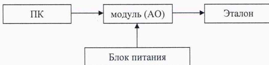
Рисунок 2 – Схема подключения ИК при воспроизведении силы постоянного тока
