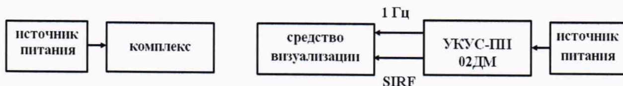
Рисунок 2 – Схема выполнения измерений
