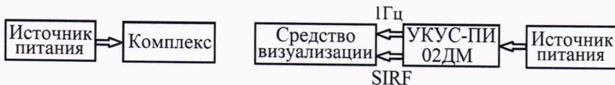
Рисунок 1 – Схема проведения поверки
