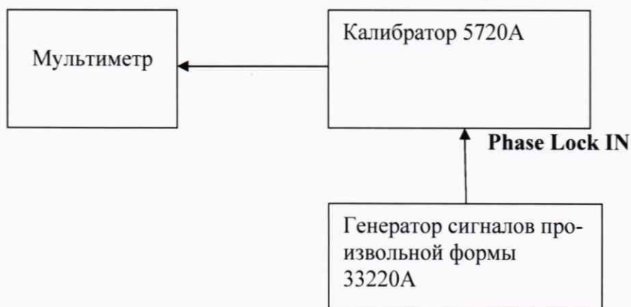
Рисунок 3. Структурная схема соединения приборов при определении абсолютной погрешности измерений частоты
