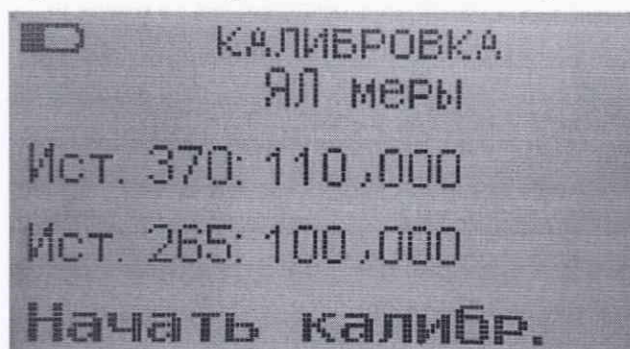
Рисунок 1 – Отображение режима «Калибровка» на ЖК-дисплее блока анализа.
