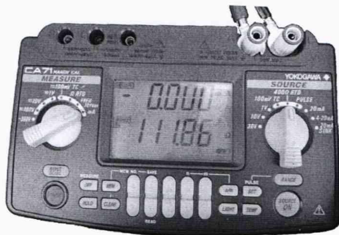
Рисунок 1 – Настройки калибратора при определении погрешностей измерения температуры.
