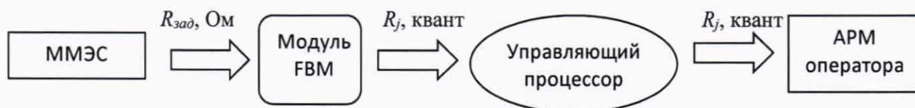
Рис. 1 - Схема подключения ММЭС и преобразования измеренного системой электрического сопротивления в цифровое значение
