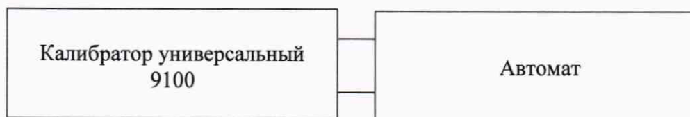
Рисунок 2 – Схема подключения для определения абсолютной основной погрешности измерений частоты переменного тока
